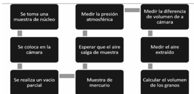
Figura 8. Esquema procedimental del método de vacío Fuente: París (2009), adaptación los autores (2018)
