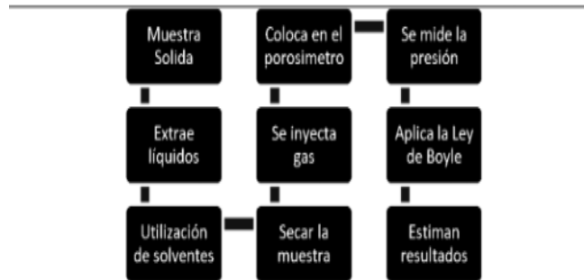
Figura 6. Esquema procedimental del porosímetro de Boyle Fuente: París (2009), adaptación los autores (2018)
