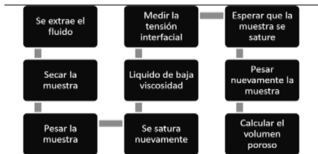
Figura 7. Esquema procedimental de la saturación de fluidos Fuente: París (2009), adaptación los autores (2018)
