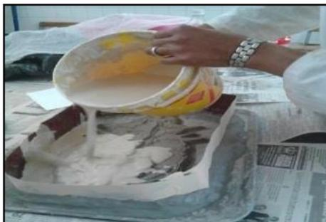
**Figura 3. Vaciado del yeso para la elaboración del molde utilizado en la confección del patrón en resina**
